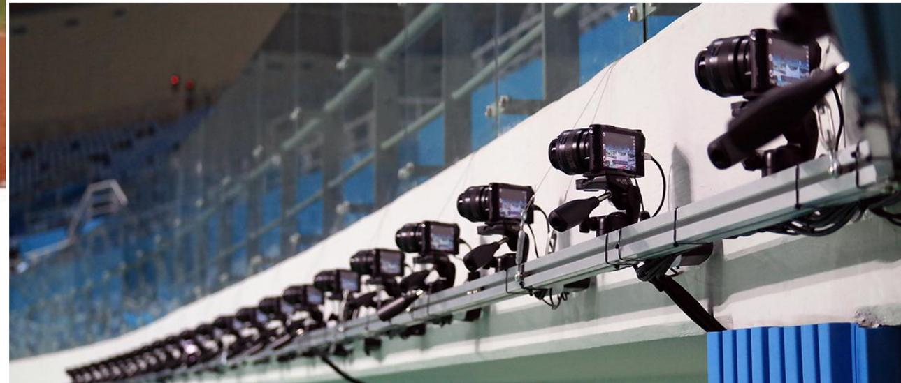
Съемочная часть такой системы представляет собой множество фотоаппаратов или кинокамер, размещенных вокруг наблюдаемой сцены.
